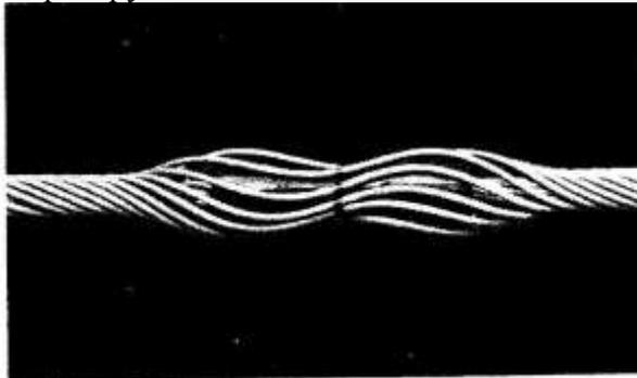
6. Точно так же, накрутите оставшиеся стержни. Оставляйте промежутки между стержнями, более или менее равномерно, вокруг вставки, чтобы не возник большой зазор, который образуется на вставке, по мере накручивания последних стержней. **УБЕДИТЕСЬ, ЧТО СТЕРЖНИ НЕ ПЕРЕСЕКАЮТСЯ И НЕ ИЗГИБАЮТСЯ.**
